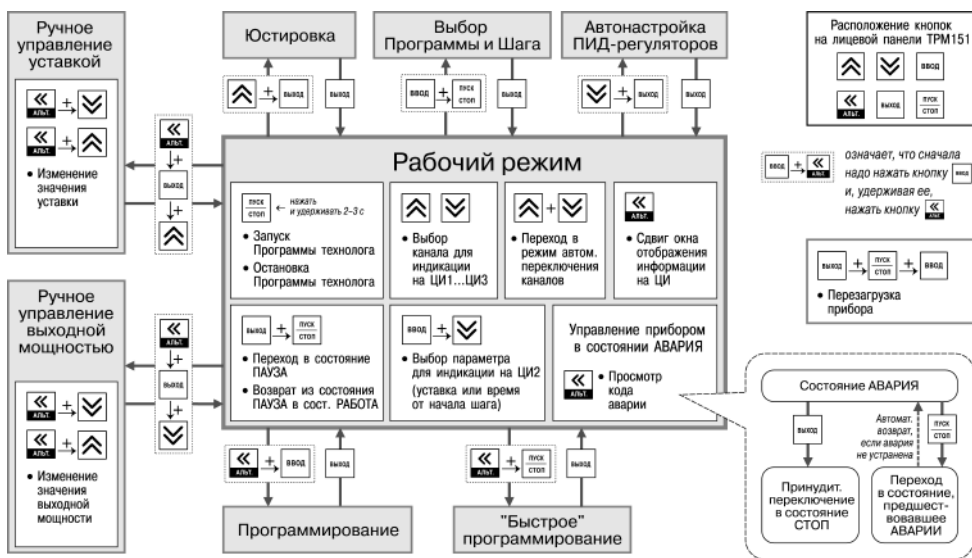
Рисунок 5.3 – Схема переключения режимов прибора
