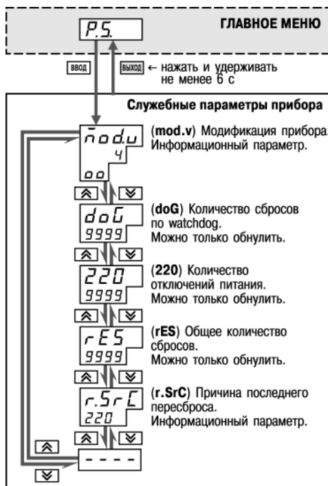
Рисунок 11.18 – Схема доступа к служебным параметрам прибора
